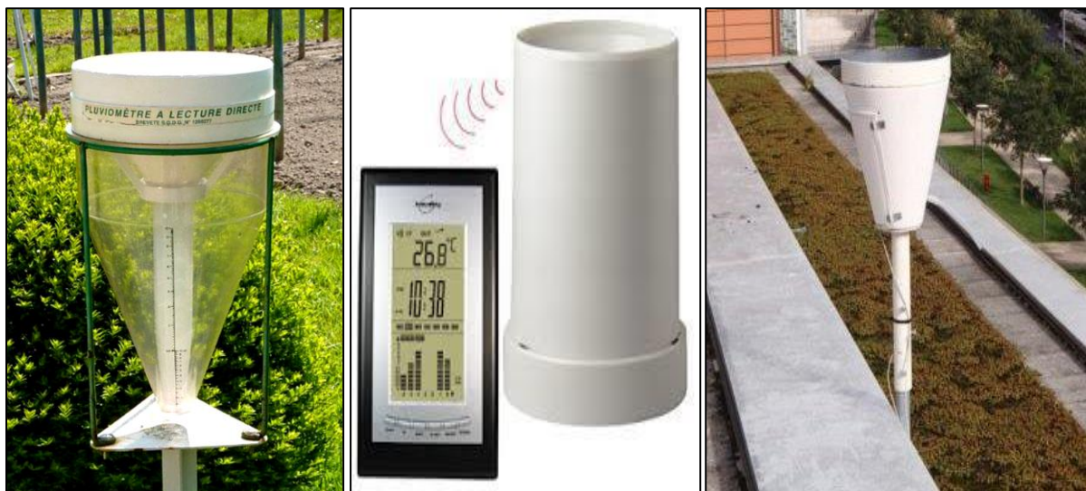
Figure 1.12 : Type des pluviomètres et pluviographes.
