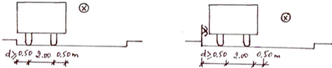
Figure 4.12. Dispositions transversales extrêmes d'un tandem B_t pour le calcul local.
