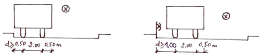
Figure 4.11. Dispositions transversales extrêmes d'un tandem B_t pour le calcul global.
