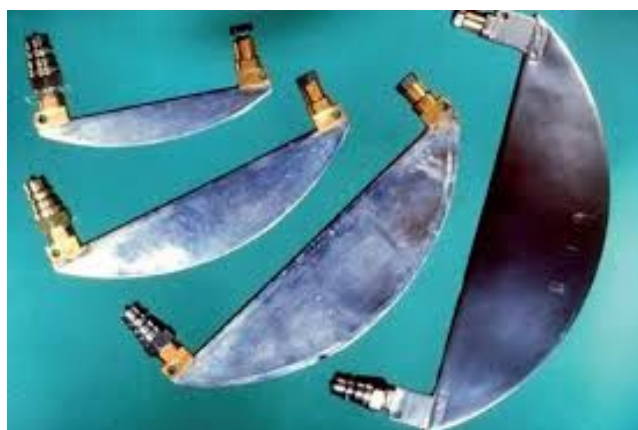
Fig. 4.12: Gamme de vérins plats pour mesure des contraintes dans le béton (de 2 à 8 cm de hauteur de pénétration) 54
