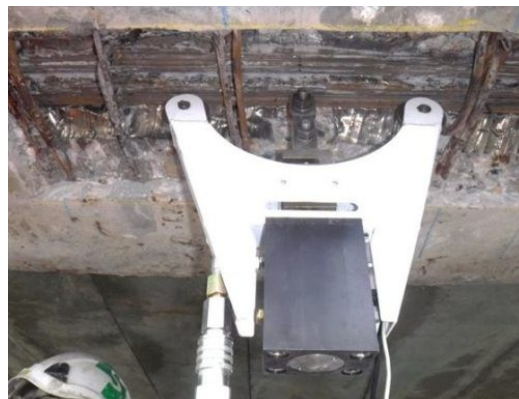
Fig. 4.11 : Mesure des forces dans la précontrainte par l'essai de l'arbalète 53
