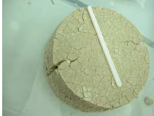
Fig. 2.2: Fissurations importantes d'un échantillon de béton soumis au test de résistance aux sulfates (le bâtonnet blanc indique la longueur initiale de l'échantillon) [3]
