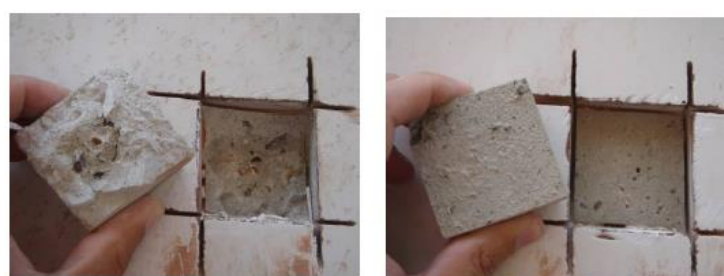
Figure 3.10 : Essai de cohésion réalisé sur deux type de béton.
