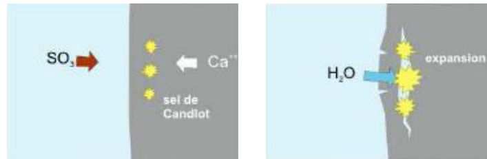
Figure 1.13 : Phénomène des attaques des sulfates [17].
