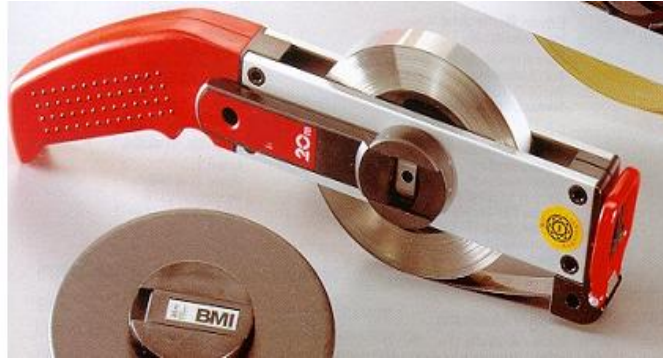
Fig. 3.4 : Ruban en acier (précision est de 1,5 mm pour 10 m).
