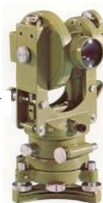
Fig. 3.11: Le tachéomètre RDS.
